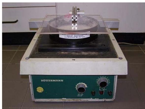
**Abb. 6.7** Rütteltisch mit befestigtem Analysensieb
