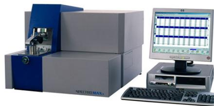
**Abb. 3.7** Funkenemissionsspektrometer
